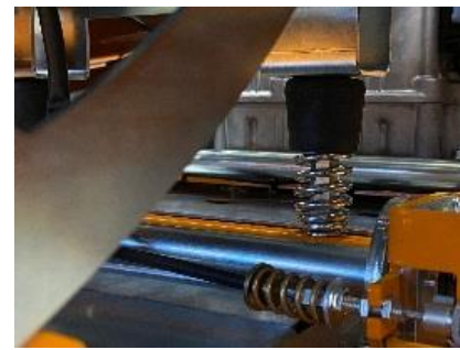
Bild 6: Spiralfeder einer Standard Sitzfederung (AS-Motor)
