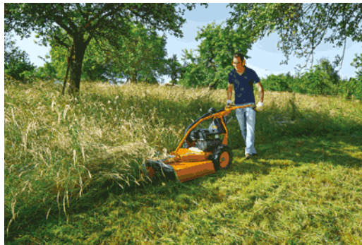
Bild 2: Der Hochgrasmäher: Er muss mit viel „Material“ fertig werden und verfügt daher meist über einen simplen Seitenauswurf oder besser über einen ausgeklügelten Heckauswurf mit geschlossener Mähhaube.
