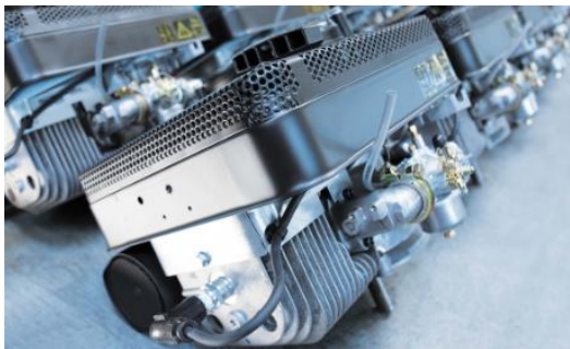
Bild 3: Der hangtaugliche Mäher: Mit einem 2-Takt-Motor ausgestattet ist die Motorschmierung unabhängig von der Position der Maschine garantiert, wodurch Motorschäden am Hang vermieden werden. Bei Rasen- und Hochgrasmähern ist die Firma AS-Motor heute der einzige Hersteller von 2-Takt-Motoren.
