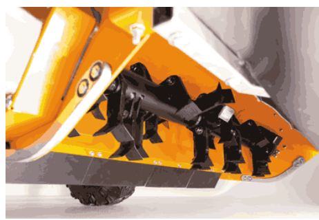
Bild 4: Der Schlegelmäher: Treffen die Schlegel auf einen Fremdkörper, so können diese wegklappen – ein entscheidender Vorteil im Vergleich zum Sichelmäher.
