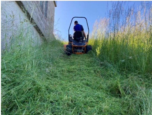
Bild 3: Vor allem beim Mähen der steilen Dämme der insgesamt 15 Speicher- und Rückhaltebecken des Wasserverbandes Obere Jagst ist der niedrige Schwerpunkt des AS 1040 YAK 4WD ein wichtiger Vorteil.
