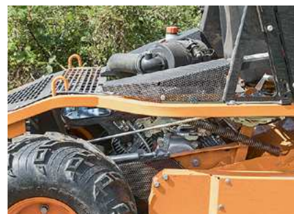
Der Zweizylinder mit 21,1 PS von B&S sitzt für einen tiefen Schwerpunkt zwischen Mulchdeck und Hinterachse.
