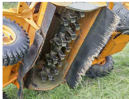
Robust: Die 56 Schlegel mit 10 cm Länge sitzen auf einer 80er Welle. Das Schnellwechselsystem erleichtert die Wartung und Reparatur.
